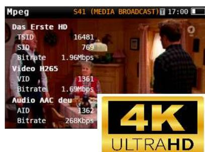
Esta função suporta o formato de compressão HEVC H.265 e permite que os sinais de vídeo sejam apresentados com a resolução máxima de 4K - UHD (3840 x 2160). A exibição pode ser no ecrã do medidor e também no ecrã de um dispositivo móvel (modo multiscreen) caso o hardware do seu equipamento suporte H.265 (geralmente um smartphone, tablet ou PC).
