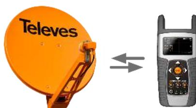
Esta função permite facilitar o trabalho de orientação das antenas parabólicas. Dependendo da zona definida, o medidor apresenta um satélite tipo e um transponder estável, autoconfigurando-se para a ligação com o LNB. Permite também activar um indicador sonoro que serve de guia para ajudar o utilizador na orientação da antena parabólica.
