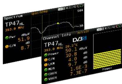
Esta função para DVB-S/S2, permite analisar de forma completa um canal de satélite em qualquer frequência de uma banda larga, compreendida entre os 250 - 2300MHz. Assim, é possível ligar o medidor diretamente a qualquer saída de um LNB Wideband (2 saídas: Vertical e Horizontal)
