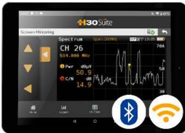
Equipado com ligação sem fios, o dispositivo permite o acesso seguro através de um dispositivo Android, iOS ou PC (navegador). Desta forma, é possível utilizar remotamente a aplicação de gestão WEB H30Suite (ref. 100016), para realizar consultas e exportações da informação armazenada no medidor, acesso aos perfis de qualidade, clonagem da configuração do medidor, registro do medidor ou consulta em tempo real do manual de utilizador.
