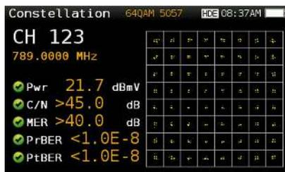
A análise das constelações é essencial para a determinação da qualidade de sinais digitais. Os diagramas de constelação ajuda a detetar a presença de ruído, flutuação de fase (jitter), interferências e saturação do sinal, todas as variáveis que podem afetar a qualidade do sinal e levam a uma interrupção de serviço. Através de uma inspeção visual do tamanho e forma dos pontos dentro da matriz de constelação, o técnico pode facilmente identificar a natureza do problema.
