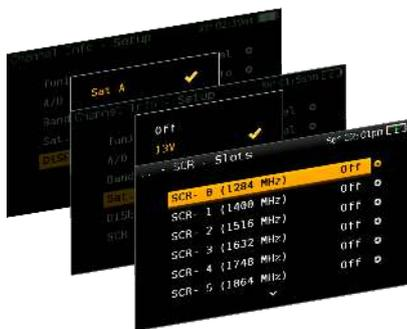
O H30Crystal está preparado para configurar os parâmetros necessários para a recepção do sinal de satélite. Para tal a partir do H30Crystal é possível alimentar, configurar parâmetros DiSEqC e também parâmetros SCR (opção 593534).
