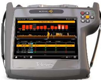
Reduzca los errores de instalación con los indicadores de pantalla Pasa/Falla, una forma gráfica que facilita y agiliza la interpretación de los resultados de medida. Se dispone de diferentes umbrales según la parte de la red a analizar: cabecera, central amplificadora, derivación, registros de conexión, vivienda de usuario, etc. Además de los valores preestablecidos, también podrá personalizar sus propios valores de umbral.
