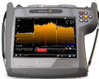
Con un procesado digital ultrarrápido conseguimos tiempos de barrido de  $<10$  ms y un elevado margen dinámico de  $>50$ dB. Está dotado de funciones avanzadas para la detección y el análisis de señales entre 5 MHz y 3300 MHz, como por ejemplo la función Waterfall, disparo por eventos, marcas RBW y VBW configurable por el usuario.
