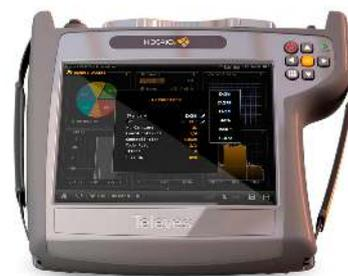
MOSAIQ6 analiza cualquier señal analógica y digital, tanto en banda terrestre, satélite o cable. Realiza todas las medidas de FM, IPTV fibra óptica, WiFi, DVB-T/T2, DVB-C Annex A, B y C y DVB-S/S2/S2X. El análisis de señales DAB y DAB+ se pueden incluir opcionalmente.
