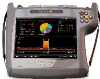
Función que permite demodular un canal DAB, ofreciendo medidas de calidad de señal como la MER y CBER, así como completa información de los servicios transmitidos: Radio info: (Ensemble, PTY, Service, Mode, Audio-, bit rate audio). Permite medir potencia entre 20 y 128dB $\mu$ V, C/N y MER de este tipo de señales.
