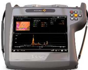
Función que permite visualizar y medir canales de TV analógica que todavía son utilizados en sistemas de TV basados en transmoduladores. Permite medir señales con niveles entre los 20 y los 128dB $\mu$ V, C/N de hasta 30dB y V/A de hasta 52dB.
