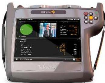
Permite demodular y analizar flujos Unicast y Multicast de IPTV, mostrando el vídeo e indicando los Bit Rates totales y de cada servicio. Además nos presenta toda la información de cada uno de los servicios, como SID, VPID, AID, perfil de vídeo, o bit rate para audio y vídeo.
