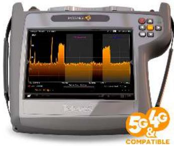
Analiza la influencia de la señal LTE sobre canales TDT, detectando la necesidad de incorporar filtros. Si la instalación lo requiere, la función LTE Check recomendará la incorporación de un filtro, simulando la situación del espectro resultante a su incorporación. Se presenta un listado de filtros para que el usuario pueda elegir el que más se ajuste a su instalación.
